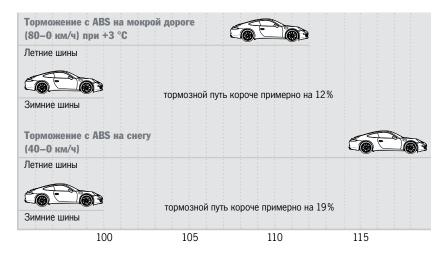
Тормозной путь в % (измерен при использовании шин по спецификации Porsche). Оптимизация тормозного пути благодаря зимним шинам Porsche. Абсолютные значения могут варьироваться.
